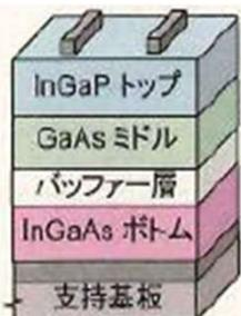
図1 3接合太陽電池の構造
